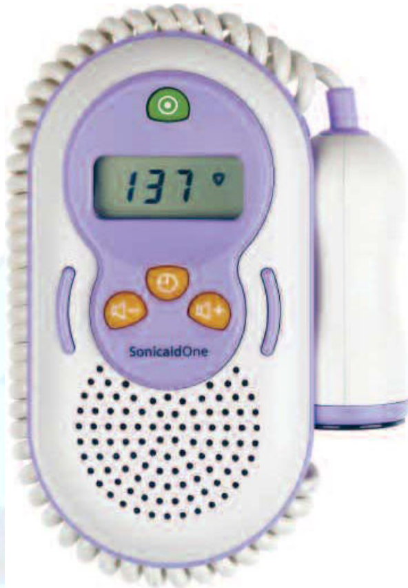
Almacenamiento del cable
